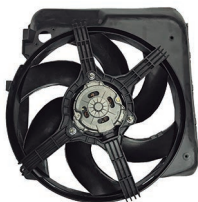
Clio 51268 // Renault Clio c./aire acond. => 1998 c/Encauzador Terminales 2.Helices 6
