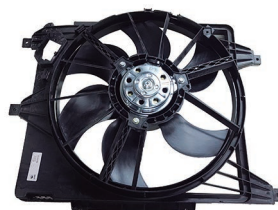
Clio FII / Symbol 7063 // Clio FII / Symbol c./aire acond./Encauzador Ø38 cm. Terminales 2.Helices 6
