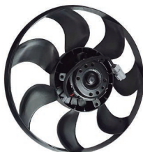
Aveo 7954MS // Aveo c./aire acond. (98808149) s./Encauzador IMPORT. Ø38cm. Terminales 2. Helices 7
