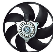
Ecosport 51410MS // Ecosport 2013=> (ficha larga) s/Encauzador Ø34cm. Terminales 2. Helices 7
