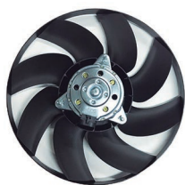
Meriva 20419S // Meriva GL / GLS s/Encauzador Ø36cm. Terminales 2.
