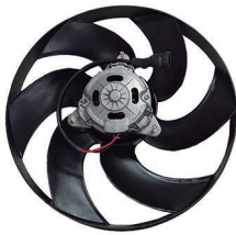
Renault 9 / 11 51463F // Renault 9 / 11 c./aire acond. 1992=> s/Encauzador Ø38 cm. Terminales 2.Helices 10
