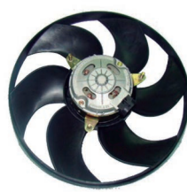
Duna / Uno 51460F // Duna / Uno c./aire acond. 1996=> s/Encauzador Ø32cm. Terminales 2. Helices 6
