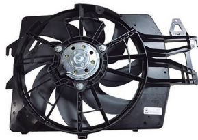
Escort 51243 // Escort Nafta / Diesel c./aire acond. 1996=> c/Encauzador Ø36cm. Terminales 2. Helices 8
