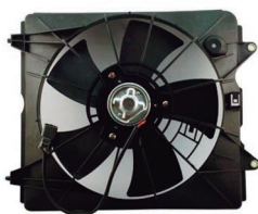
Honda 51528M // Honda CRV Ø31 cm. Terminales 2. Helices 5
