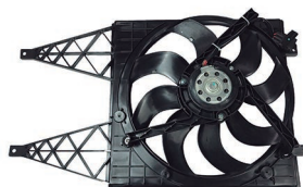
Fox / Suran 10370 01M // Fox / Suran Diesel c./aire acond. (ficha 3 term.) c/Enc. Ø38 cm. Terminales 2. Helices 7
