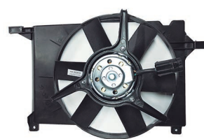
Corsa 51337-01M // nafta 1.6 c./aire acond. (1341307) c/Encauzador Ø31cm. Terminales 2
