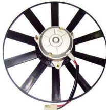
Renault 9 / 11 20109 // Renault 9 / 11 s./aire acond. => 1992 s/Encauzador Ø35 cm. Terminales 2.Helices 10
