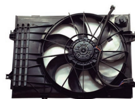
Hyundai 51536M // Hyundai Tucson / Sportage c/Encauzador Terminales 2.
