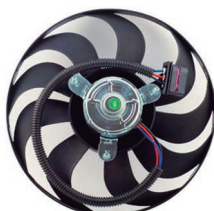
Bora / Golf IV 10377M // Bora - Golf IV (Auxiliar) s/Encauzador Ø29 cm. Terminales 3. Helices 9
