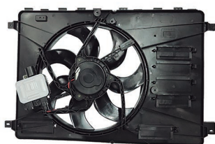
S-Max 20427 // S-Max c/modulo) c/En- cauzador Ø38,5cm. Terminales 2. Helices 7
