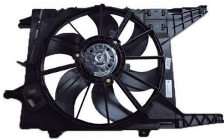
Megane FIII 51514M // Megane FIII 2005=> (8200151465) c/Encauzador Ø38 cm. Terminales 2.Helices 6
