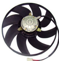
Ka / Fiesta 50242F // Sierra aspirante s/Encauzador Ø32cm. Terminales 2. Helices 8.
