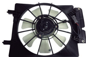
Honda 51532M // Honda Fit 2009=> c/ Encauzador Ø30 cm. Terminales 2.
