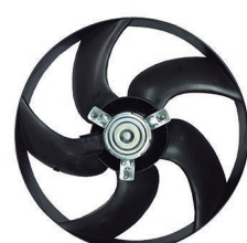
Peugeot 206 51465 // Peugeot 206 s./aire acond. s/Encauzador Ø39 cm. Terminales 2.Helices 5.
