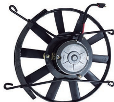
Renault 18 50227 01F // Renault 18 (1600) s./ aire acond. c/Encauzador Terminales 2.Helices 10.
