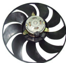
Palio / Siena 51282F // Palio / Siena Diesel c./ aire acond. =>2001 s/Encauzador Ø39cm. Terminales 2. Helices 9
