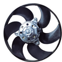
Duna / Uno 51460 // Duna / Uno c./aire acond. 1996=> s/Encauzador Ø32cm. Terminales 2. Helices 6
