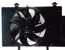
Fiesta 51412M // Fiesta Kinetic 2013=> (ficha corta) c/Encauzador Ø34cm. Terminales 2. Helices 7
