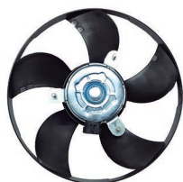
Uno Fire 51309M // Uno Fire c./aire acond. s/Encauzador Ø32cm. Terminales 2.
