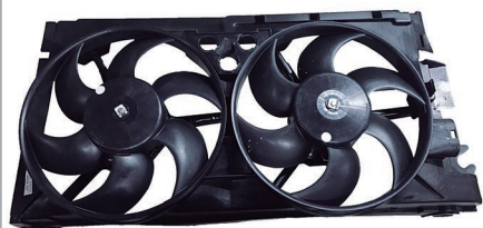
Peugeot 306 N3 51247 // Peugeot 306 N3 c./aire acond. Doble c/Encauzador. Helice 32cms
