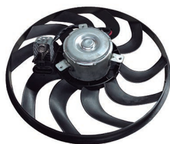
Agile / Montana 10119MS // Agile c./aire acond. / Montana (94759608) s./Encauza- dor. Ø36cm. Terminales 3
